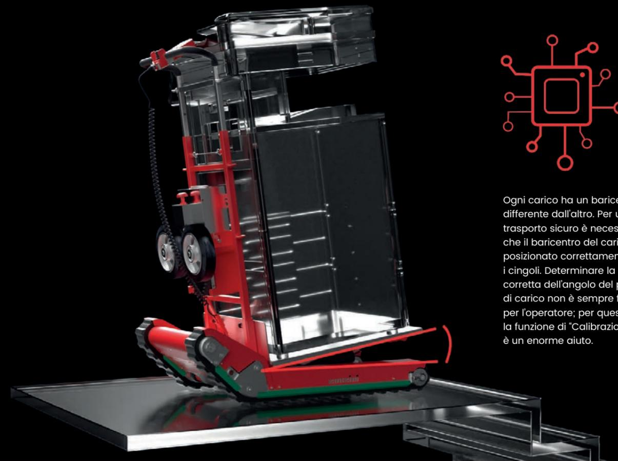
Ogni carico ha un baricentro differente dall'altro. Per un trasporto sicuro è necessario che il baricentro del carico sia posizionato correttamente lungo i cingoli. Determinare la posizione corretta dell'angolo del piano di carico non è sempre facile per l'operatore; per questo motivo la funzione di "Calibrazione" è un enorme aiuto.
