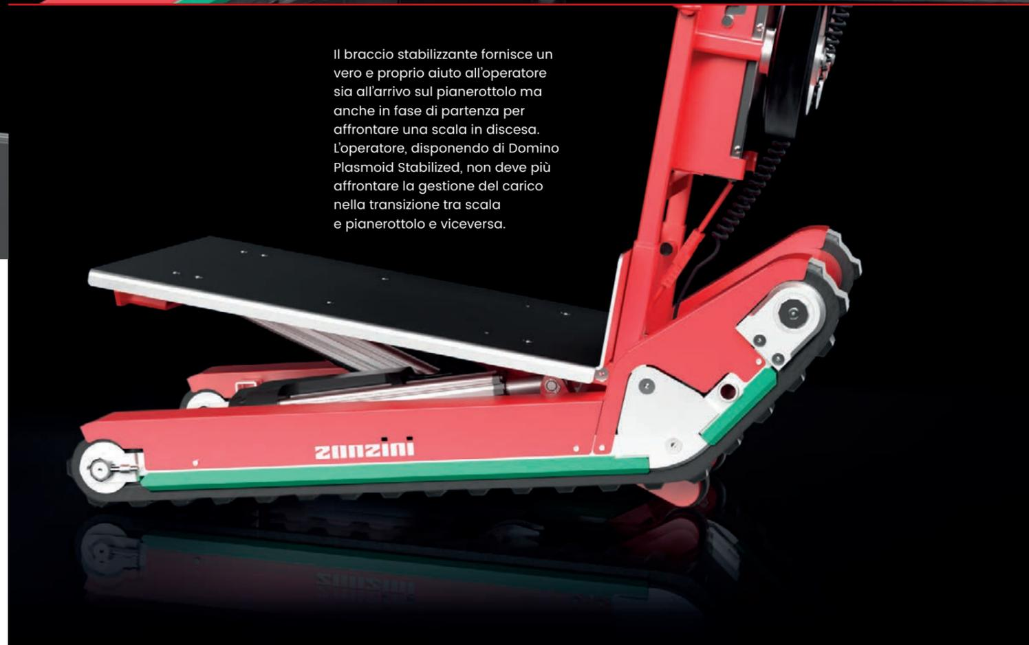
Il braccio stabilizzante fornisce un vero e proprio aiuto all'operatore sia all'arrivo sul pianerottolo ma anche in fase di partenza per affrontare una scala in discesa. L'operatore, disponendo di Domino Plasmoid Stabilized, non deve più affrontare la gestione del carico nella transizione tra scala e pianerottolo e viceversa.
