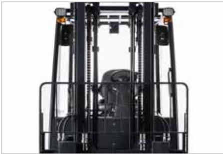
Tubi idraulici e catene ordinatamente disposti forniscono una visibilità frontale chiara attraverso l'ampio montante.
